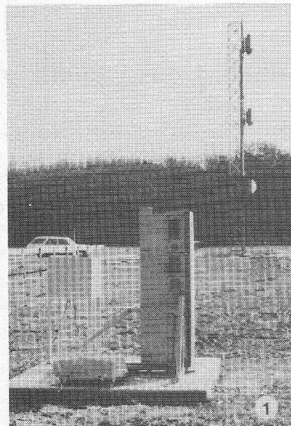
Afb 1 Het microgolfmeetsysteem voor de elevatiehoek (links) is veel kleiner dan de gangbare overeenkomstige ILS-unit (rechts).
